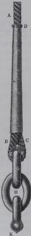
welches gleichsam das Dehr für das hindurchgehende Kettenglied *G* bildet. Die Drähte des zurückgebogenen Seilendes *CD* verlaufen sich in dem Seilstücke *AB*, und der dadurch gebildete Seilbund von etwa 1 Meter Länge wird durch eine schraubenförmige Umwicklung von Draht fest zusammengehalten. Um das Seilende nach Bedürfnis ein- und auszuhängen zu können, wird das hufeisenförmige Kettenschloß *HK* eingeschaltet, dessen Bolzen *K* in den Bügel geschraubt ist.
