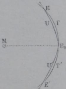
Es ist klar, daß man auch die Conchoidenlenker umkehren kann, indem man den Punkt  $A$  durch zusätzliche Bewegung um  $-s$  in Ruhe setzt, und die zu führende Kolbenstange mit den beiden Lagern für  $B$  und  $M$  verbindet, in solcher Art
