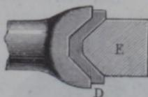
oder Kreuzkopfe *B*, welcher durch den Keil *C* auf der Kolbenstange befestigt und mit zwei angegossenen Gleitbacken *D* versehen ist, welche zwischen den beiden parallelen Führungsschienen oder Cou-lissen *E* sich führen. Der Kreuzkopf ist in der Mitte gabelförmig und zur Aufnahme eines Querbolzens *F* geeignet gemacht, an welchem letzteren das Auge der Schubstange angreift. Die Gleit-
