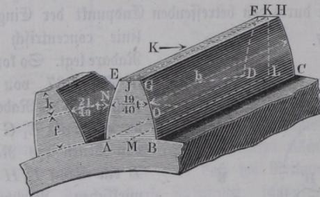
auf den Zahn  $AGFC$ , Fig. 268, wirkende Druck  $K$  ist bestrebt, den Zahn in der Anhaftungsfläche  $ABCD$  desselben an den Radkranz abzubrechen, da für diese Fläche das Bruchmoment am größten, nämlich  $Kl$  ist, unter  $l$  die ganze Zahnlänge  $MJ$  verstanden. Der Druck
