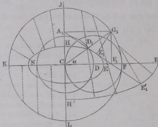
bahn, welcher sich in dem Kreise  $DD_1$  vom Halbmesser  $a$  und zum Mittelpunkte  $C$  bewegt. Man findet den Ort eines Punktes  $E$ , welcher von  $D$  um  $DE = e$  absteht, in irgend einem Augenblicke, wenn der Pol von  $F$  nach  $G_1$
