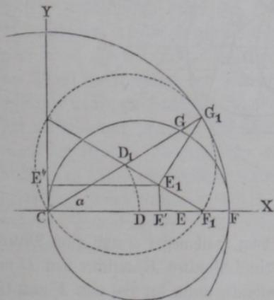
Punkten des bewegten Körpers hat nur der Mittelpunkt  $D$  des rollenden Kreises, Fig. 11, einen unveränderlichen Abstand  $r = a$  von dem Pol, daher auch nur dieser Punkt seine Bahn mit unveränderlicher Geschwindigkeit durchläuft, wenn man voraussetzt, daß die Rollung mit gleichbleibender Wechselgeschwindigkeit  $u$  geschehe. Die Geschwindigkeit  $v = r\omega$  des Punktes  $D$  ist demzufolge
