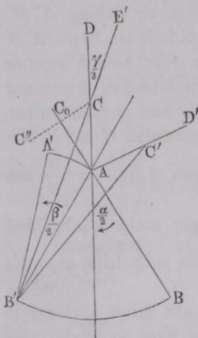
$C$  erhält man dann denjenigen Punkt, welcher durch die Drehung  $\alpha$  um  $A$  nach  $C'$  und durch die entgegengesetzte Drehung  $\beta$  um  $B'$  wieder nach  $C$  zurückgeführt wird. Dieser Punkt repräsentirt also die in ihm normal zur Bewegungsebene zu denkende Axe der resultirenden Drehung, deren Betrag gleich  $2 D C E' = \gamma = \alpha - \beta$  ist, woraus die oben angeführte Regel sich ergibt.
