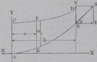
Seilstück, dessen tiefster Punkt *A* ist, so daß daselbst die Tangente des Seiles horizontal ausfällt, und dessen Belastung in bekannter Weise der Belastungslinie *CFD* gemäß derart angenommen ist, daß die Ordinate *EF* in dem beliebigen Punkte *E* daselbst die spezifische Belastung *q* nach einem gewissen willkürlich ge-
