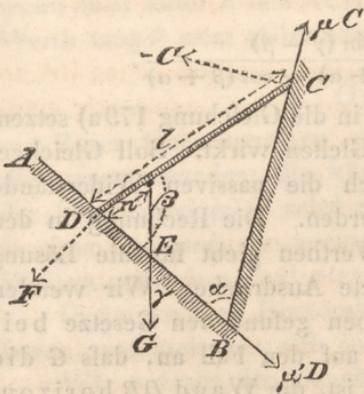
Indem wir die Richtung  $DA$  als positiven Zweig der ersten Axe, die Richtung  $DF$  als positiven Zweig der zweiten Axe ansehen, und die Winkel bestimmen, welche nach § 77 die Krafrichtungen mit der Richtung  $DA$  bilden, finden wir als auf das bewegliche System angebrachten Kräfte:
