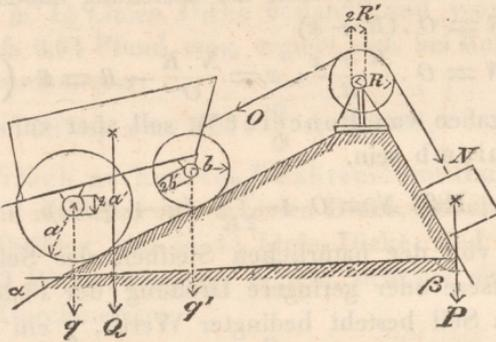
Halbmesser  $R$ , ist. Die Räder des Wagens haben die Halbmesser  $a$  und  $b$  und die Zapfenhalbmesser  $a'$  und  $b'$ , die Last  $Q$  vertheilt sich auf die beiden Räder, so dass das Rad  $a$  die Last  $q$ , das Rad  $b$  die Last  $q'$  zu tragen hat. Die Seilenden sind parallel mit den geneigten Ebenen.
