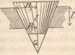
auch  $\cos \alpha$  nahezu gleich 1, und wenn  $\alpha$  gleich Null wird, so werden diese Werthe genau erreicht. Man hat daher für einen cylindrischen Zapfen, der nur in einer Seite aufliegt, oder, der doch nur eine sehr kleine Berührungsfläche hat, falls der Druck normal zur Axe ist:
