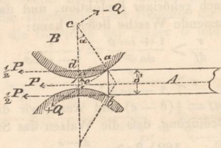
Im andern Falle dagegen würde das Stück  $A$  in der Richtung  $aQ$  gegen die Walze (selbst wenn dieselbe still stände) abgleiten können; der Druck  $W$ , welcher sich der Formveränderung des Stückes in der Richtung  $ab$  entgegengesetzt ist also nach dieser Richtung und normal dazu zu zerlegen in die beiden Drucke  $W \cdot \sin \alpha$  und  $W \cdot \cos \alpha$ . Dieser letztgenannte Druck wird durch den Widerstand der Walze aufge-
