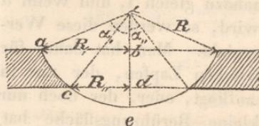
c) Kugelförmiger Zapfen mit einem Kugelhalbmesser =  $R$  und von dem Centriwinkel  $2\alpha_i$  bis zu dem Centriwinkel  $2\alpha_{II}$  eingesenkt.
