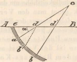
liegende Normalen sind: mithin ist Winkel  $adb' = acb = d\alpha$ . Nun können wir die Bewegung in dem Kurvenelement hervorgebracht denken durch eine Normalkraft, welche das gleitende Stück gegen die Kurve preßt, durch den Widerstand derselben aufgehoben
