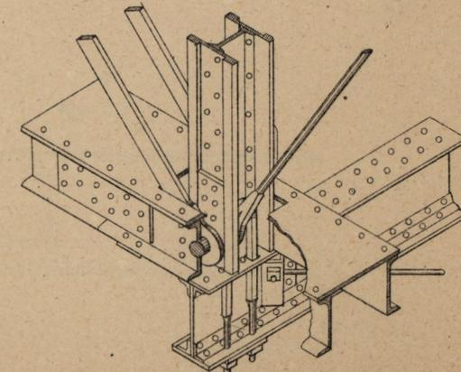
Fig.8. - Assemblage d'un montant avec la corde supérieure.
