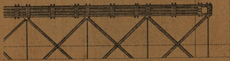
Fig.6\_\_Assemblage des bras avec la corde inférieure
