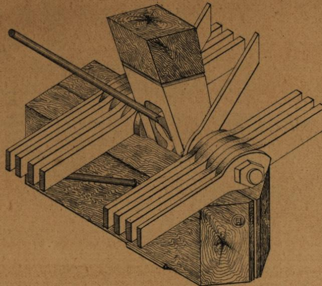
Fig.8\_\_Assemblage des montants extrêmes avec la corde inférieure
