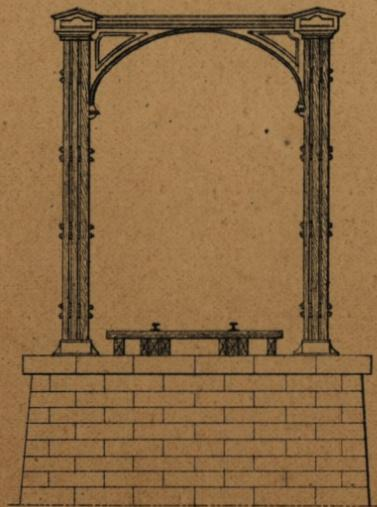
Fig.5\_\_Assemblage des bras avec la corde supérieure
