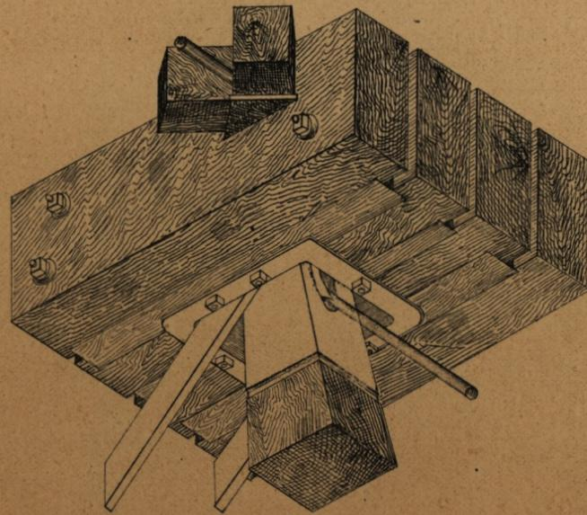
Fig.7\_\_Assemblage des montants extrêmes avec la corde supérieure
