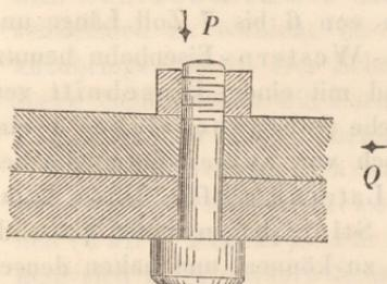
Nach dem in § 27 aufgestellten Principe sollen die beiden Stücke mit einem solchen Drucke gegeneinander geprest werden, daß die hierdurch entstehende Reibung genügend ist, um dem auf Verschieben wirkenden Drucke Wider-
