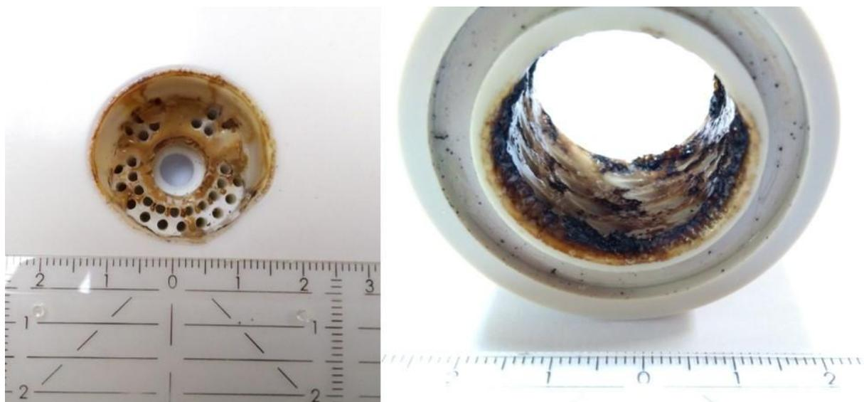
Abbildung 4-1: Schadensbild an den beiden Bauteilen „Deckel“ und „Swirler“ auf Grund Rückzündung
