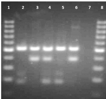
Abb. 16 - Tetra-Primer-ARMS-PCR, Annealing-T.: 59,6°C, 1,5 mM  $MgCl_2$ . 1: 100 bp-Ladder; 2: Muchamiel UMH 916 Pfl. 2 (Tm-2a/Tm-2a-Referenz); 3: Moneymaker G421 Pfl. 1 (tm-2/tm-2-Referenz); 4: Goldita EP1 Pfl. 9 (tm-2/Tm-2a); 5: Goldita EP1 Pfl. 5 (Tm-2a/Tm-2a); 6: Goldita EP1 Pfl. 1 (tm-2/tm-2); 7: Negativkontrolle ( $H_2O$ ); 8: 100 bp-Ladder.
