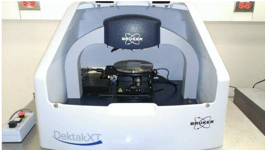
Abbildung 10: Das Profilometer DektakXT von Bruker dient dem taktilen Vermessen und erlaubt eine graphische zwei- oder dreidimensionale Darstellung der Oberflächentopographie.
