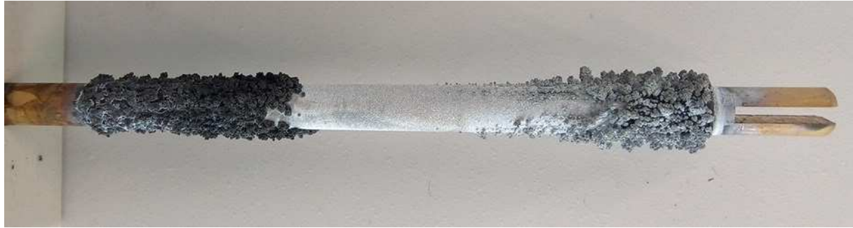
Abbildung 7: Zylinder eines RZH-Versuchs mit drei voneinander deutlich unterscheidbaren Zinkmorphologien, v.l.n.r. filamentös, kompakt und dendritisch auf Nickelsubstrat ( 60^{\circ}\text{C} , v = 3 \text{ cm/s} , 8 \text{ M KOH} , 0.5 \text{ M ZnO} , 300 \text{ C/cm}^2 , \gamma = 0.33 , t_{\text{on}} = 50 \text{ ms} , j_m = 50 \text{ mA/cm}^2 ).
