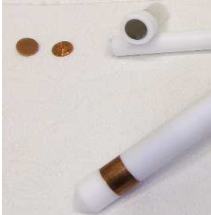
Abbildung 8: Hier sind die rotierende Zylinderelektrode mit Zylinder sowie der Aufsatz für die rotierende Scheibenelektrode und zwei entsprechende Einsätze für die Scheibenelektrode dargestellt.
