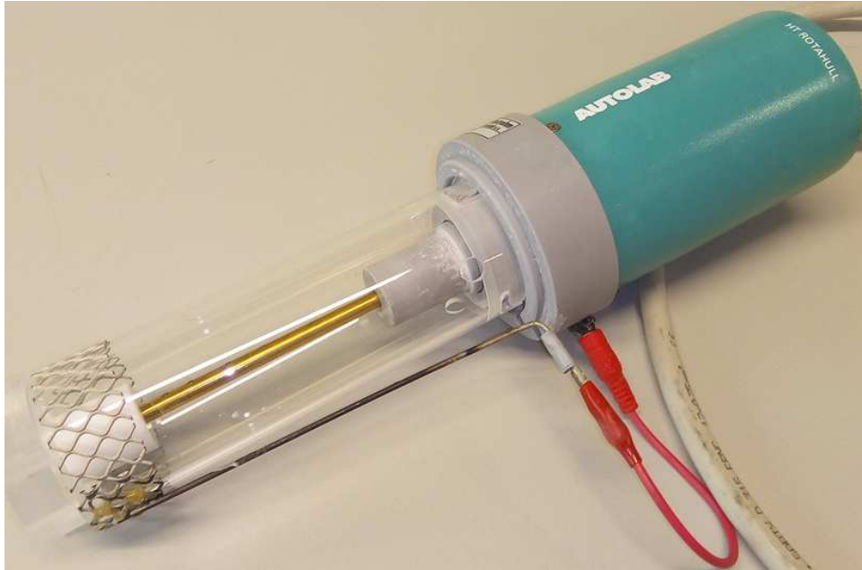
Abbildung 5: Hull-Zelle mit rotierender Zylinderelektrode (RZH) zur Untersuchung galvanischer Bäder unter definierten hydrodynamischen Bedingungen.
