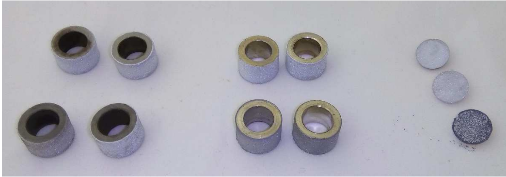
Abbildung 27: Zinkabscheidung auf Stahl- und Kupferzylindern sowie Kupferscheiben der RZE- bzw. RDE-Versuche.
