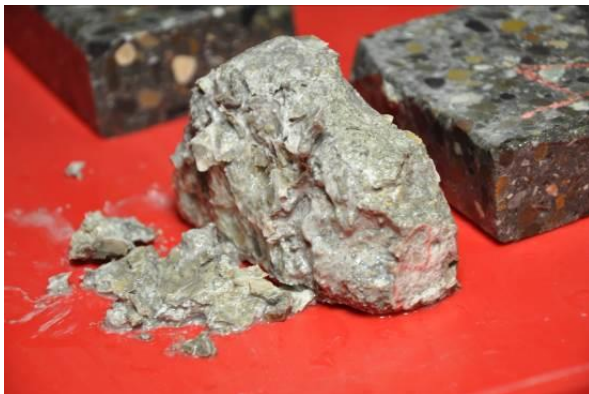
Abbildung 34: Auflösungserscheinungen nach 30-monatiger Einlagerungszeit in einer 2% Na 2 SO 4 + Gips+ Kalzit Lösung bei ca. 5°C der Referenzprobe (sulfatbeständiger Spritzbeton nach RL-Spritzbeton) (Mittermayr u. a. , 2017)
