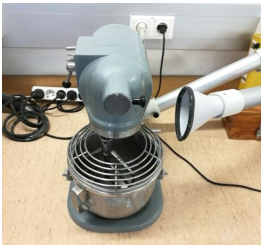
Abbildung 38: Verwendeter Mörtelmischer (Hobart Mischer)
