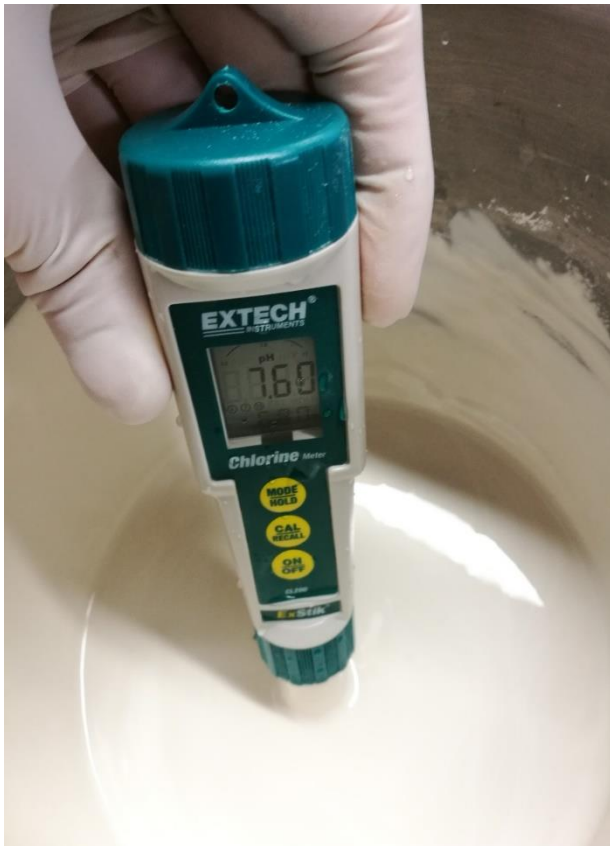
Abbildung 50: pH- Messung eines Leims (MEF-CAL-100 + Leitungswasser) mit Extech© pH 105
