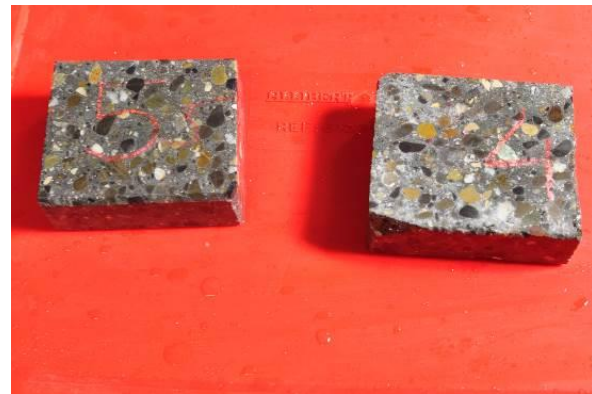
Abbildung 35: Schadensfreie Probe der entwickelten Rezeptur nach 30-monatiger Einlagerungszeit in einer 2% Na 2 SO 4 + Gips+ Kalzit Lösung bei ca. 5°C (Mittermayr u. a. , 2017)
