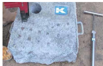
Abbildung 17: Prüfung der Festigkeit von jungem SPB mittels Setzbolzengerät an einer Spritzkiste (Schwenk Zement KG, 2015)
