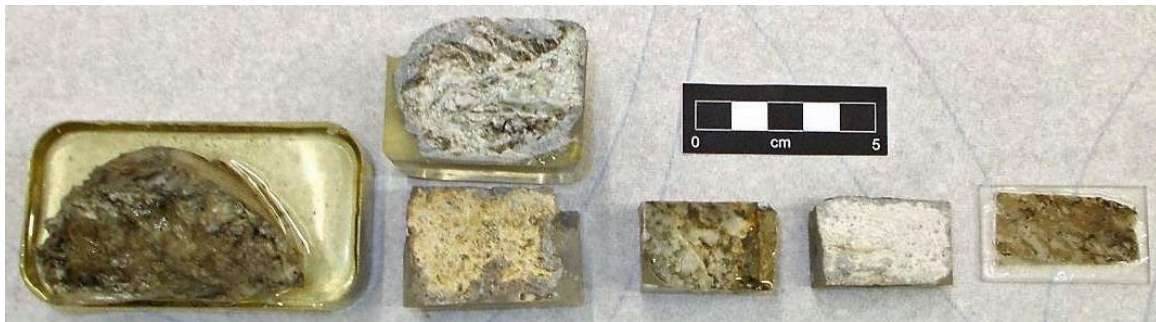
Abbildung 5.1 Vom Probenstück bis zum Dünnschliff
