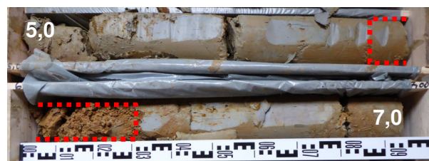
Abb. 11: Einheit II - Rutschmasse. Aufnahme aus Kernbohrung KB1, Tiefe 5,0 bis 7,0 m. Markierung: Eisenoxidlage im Bereich der primären Bewegungsbahn bei 5,8 bis 6,3 m Tiefe (Probenserie CL.1A bis CL.1F).
