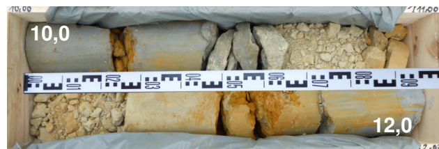
Abb. 12: Einheit III - Ton/Silt/Feinsand-Wechsellagen, verfestigt. Aufnahme aus Kernbohrung KB1, Tiefe 10,0 bis 12,0 m.
