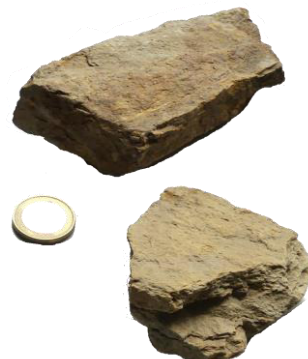
Probe GS.W3 Stark verwittert: Gestein vollständig entfärbt und entfestigt
