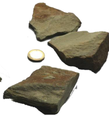
Probe GS.W2 Trennflächen oxidiert, Festigkeit deutlich reduziert
