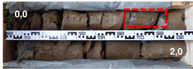
Abb. 10: Einheit I - Deckböden. Aufnahme aus Kernbohrung KB1, Tiefe 0,0 bis 2,0 m. Markierung: Anschüttungsmaterial bei ca. 0,6 bis 0,9 m Tiefe.
