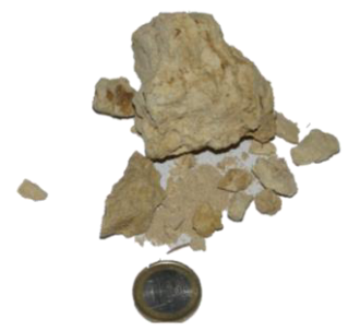
Probe GS.W4 Sehr stark verwittert: Das Gestein ist stark zersetzt und ausgebleicht
