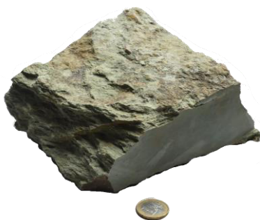
Probe GS.W1 Unverwittert: Gestein weitgehend intakt
