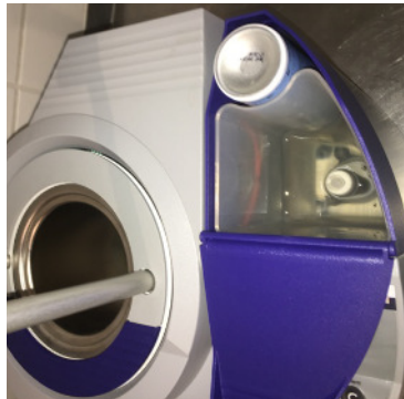
Abb. 4.17: Wassertank (unten) und Öldosiereinheit (oben) des DAC Universal Geräts
