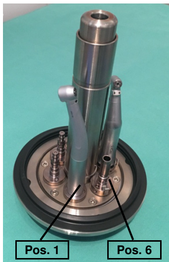
Abb. 4.16: Deckel des DAC Universal Geräts mit Adaptern und aufgesteckten Übertragungsinstrumenten
