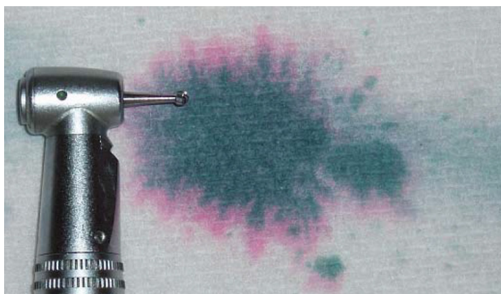
Abb. 1.7: Kontamination der Innenflächen des Übertragungsinstrumentes durch den Rücksaugeffekt [15]
