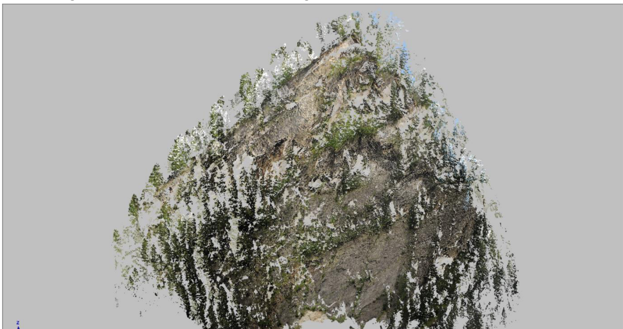
Abbildung 21: Der ausgeschnittene und Datenbereich der Felswand mit den Farbinformationen aus den Fotos
