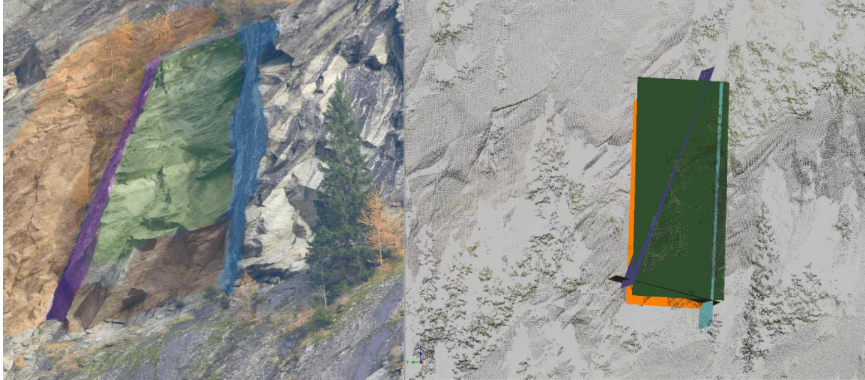
Abbildung 54: Links Foto des Blockes und rechts das virtuelle Modell mit den konstruierten Trennflächen
