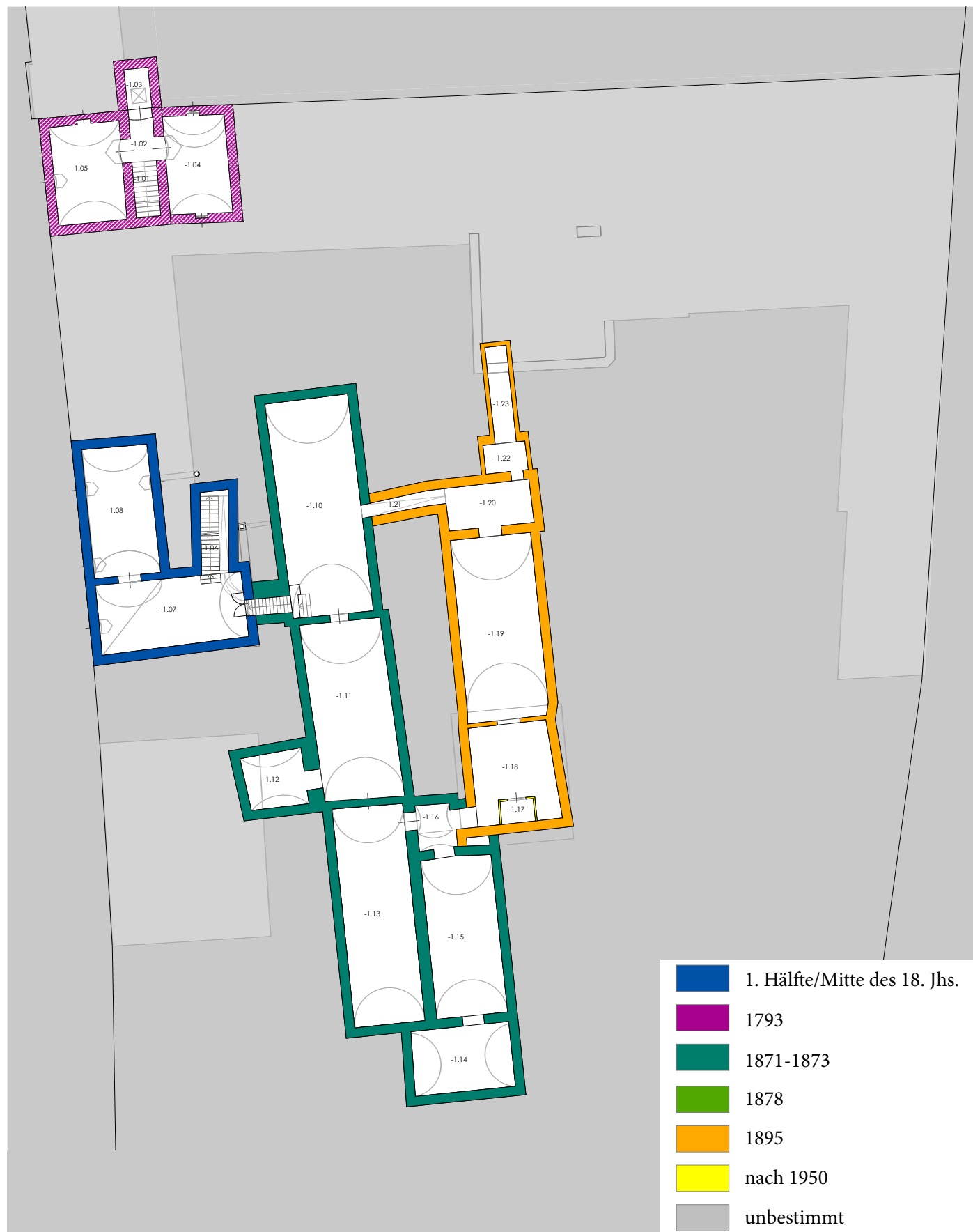
Abb. 64. Baualtersplan, Grundriss Kellergeschoss
