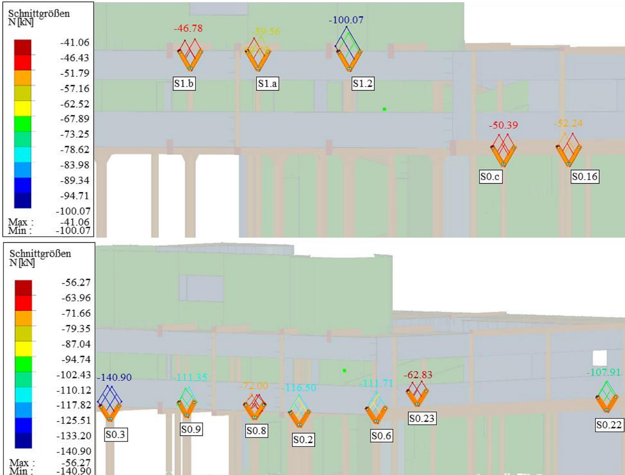
Abb. Anhang C-6: Normalkräfte für d=140mm (oben), b=140mm (unten) und LK2 (West-Ansicht)
