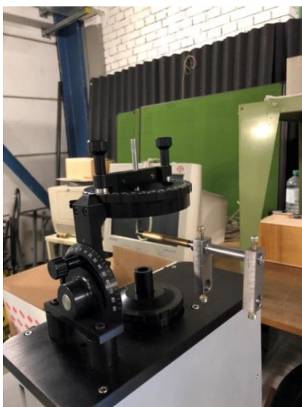
Abbildung 30: Einspannung Sondenhalterung in den Pitch- und Yaw Manipulator
