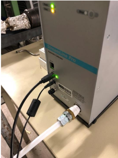
Abbildung 29: Anschluss Luftmassenstroms an den Kalibrierkanal
