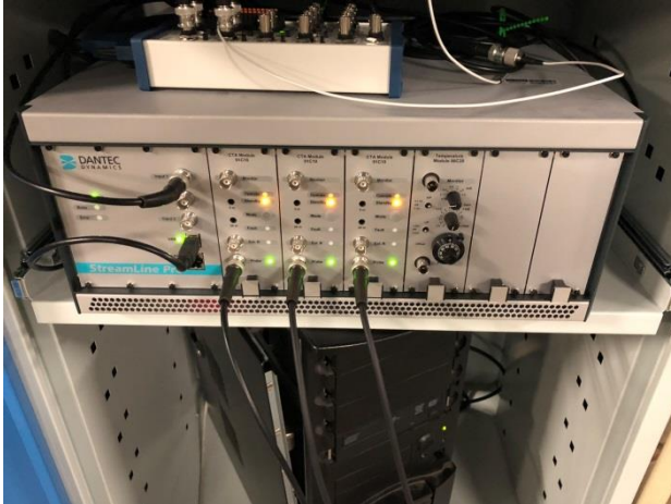
Abbildung 33: Anschluss BNC-Kabel an das CTA-System
