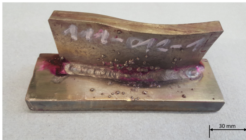
Abbildung 4-20: Schweißprobe 111-012-1; Verbund aus Altstahl und S235 JR, Sichtprüfung (VT)
