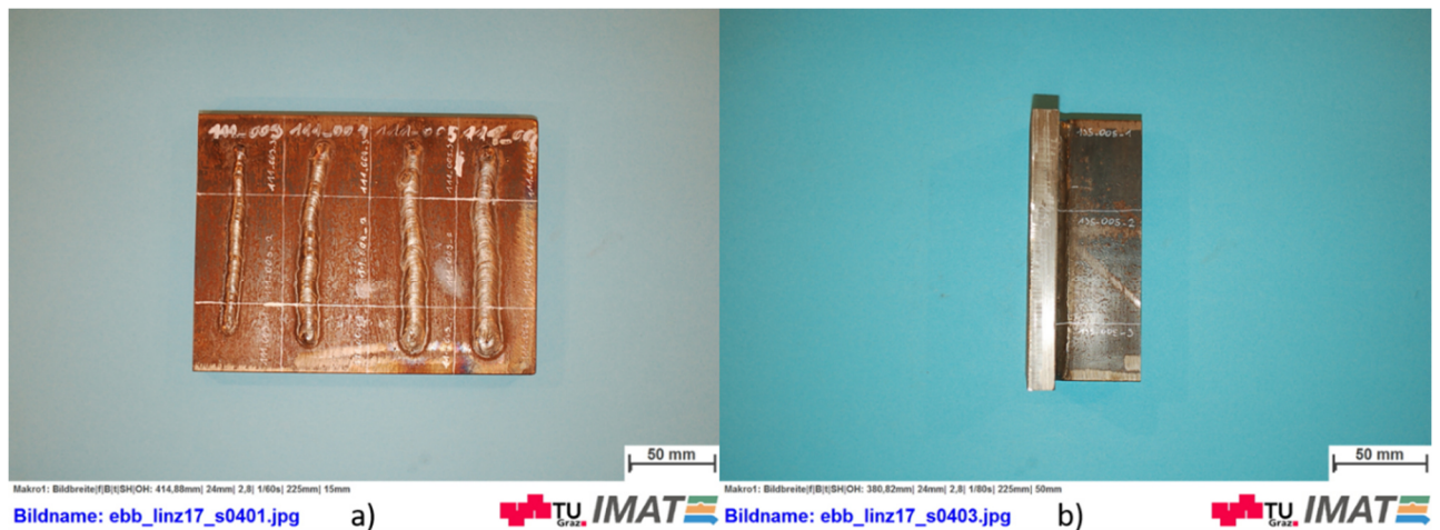
Abbildung 4-16: Schnittpreparierung a) Auftragsschweißung; b) Kehlnahtschweißung
