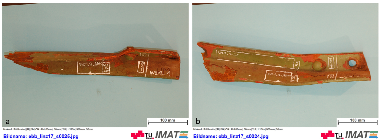
Abbildung A-0-3: Detailansicht zur Probenentnahme WL1
