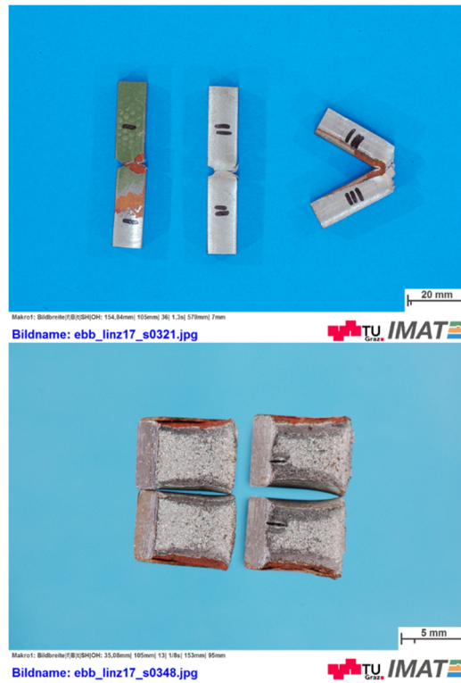
Abbildung D-0-1: Übersicht Kerbschlagbiegeprobe WL1_2_KB
