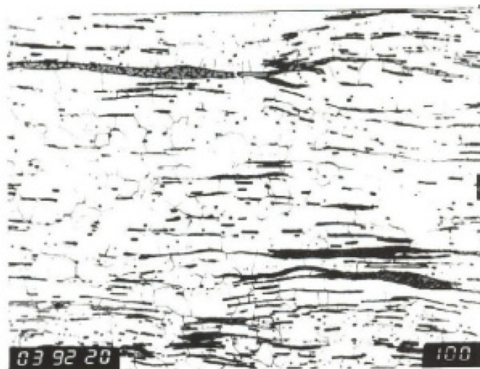
Abbildung 2-5: Schweißisen aus einer Brücke von 1890 36
