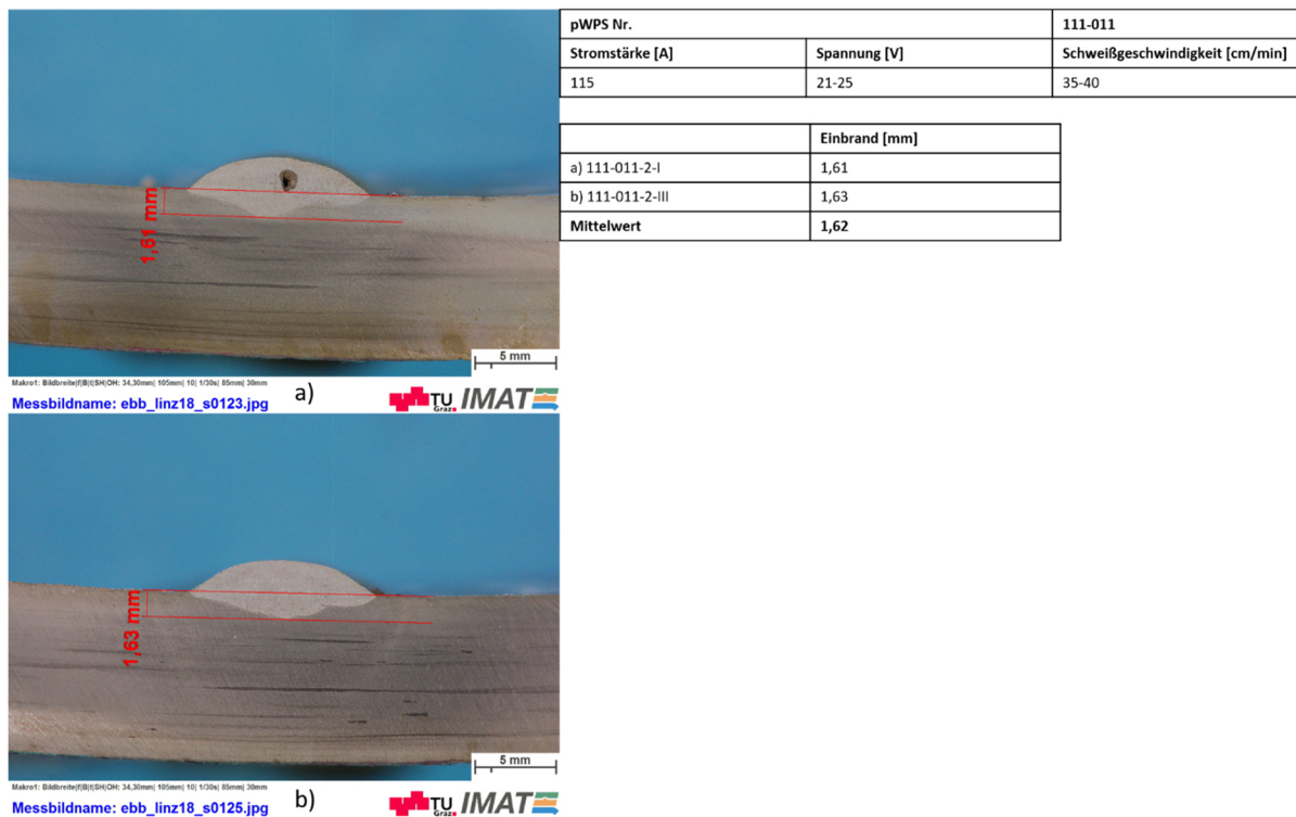
Abbildung H-0-2: Einbrandtiefenmessung Hauptversuch 111-011-2
