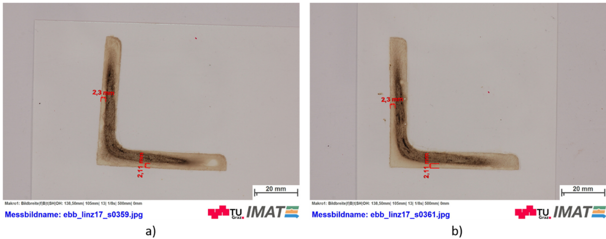
Abbildung B-0-1: Speckschichtdickenmessung a) WL1_1_BM; b) WL1_2_BM
