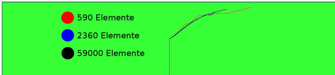
Abbildung 27: Asymmetrischer Träger mit Mittelriss, MAXPS, Netz mit 590, 2360 und 59000 Elementen
