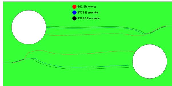
Abbildung 55: Vergleich der Netze mit der Methode der kohäsiven Segmente, Kriterium MAXPS, 681, 3776 und 23360 Elemente, Eingespanntes Gebiet mit zwei Löcher und Doppelriss
