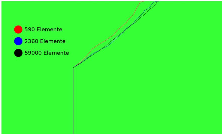
Abbildung 30: Vergleich der Netze mit dem Modell von BK, Asymmetrischer Träger mit Mittelriss, Netz mit 590, 2360 und 59000 Elementen
