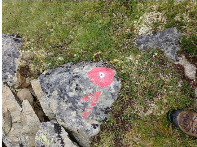
Abbildung 4.7.: Passpunkt im Fels stabilisiert Quelle: eigene Aufnahme
