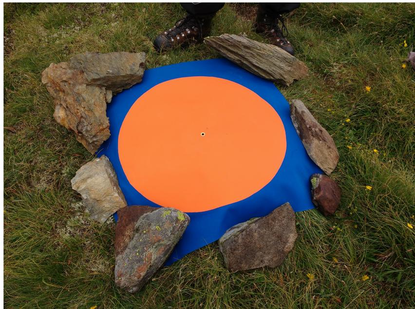
Abbildung 4.1.: Entwurf Bodenpasspunkt 2016 Quelle: eigene Aufnahme
