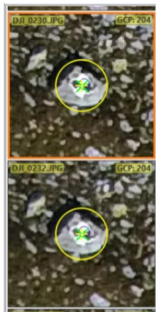
Abbildung 5.3.: Markieren der Passpunkte in Pix4D Quelle: eigene Darstellung
