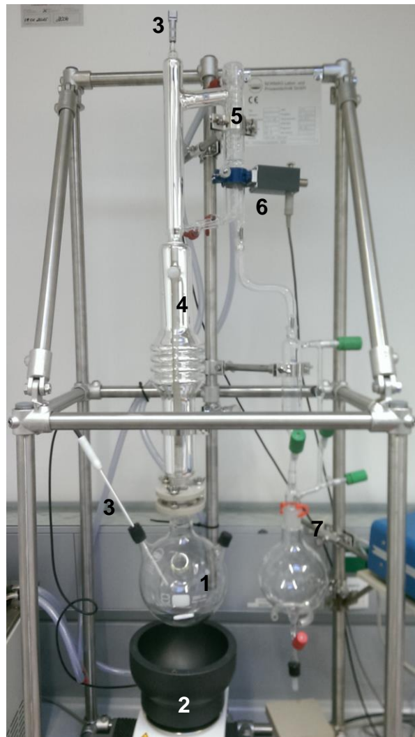
Abbildung 6-1: Aufbau der Labor-Rektifikationskolonne Fa. Normag, DN 30: Rundkolben (1), Heizpilz mit Aluminiumaufsatz (2), Temperaturmessstellen (3), Glasschuss (4), Kopfkondensator (5), Rücklaufteiler (6) und Destillatbehälter (7)
