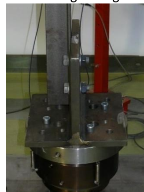
Abb. 2-11: Darstellung der Verschiedenen Lagerungsbedingungen: BC1 – eingespannt, BC2 – Scharnier, BC3 - gelenkig
