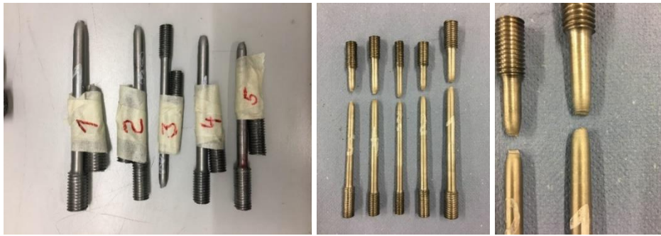
Abb. 2-7: Rundproben nach Versuchsdurchführung der Zugversuche
