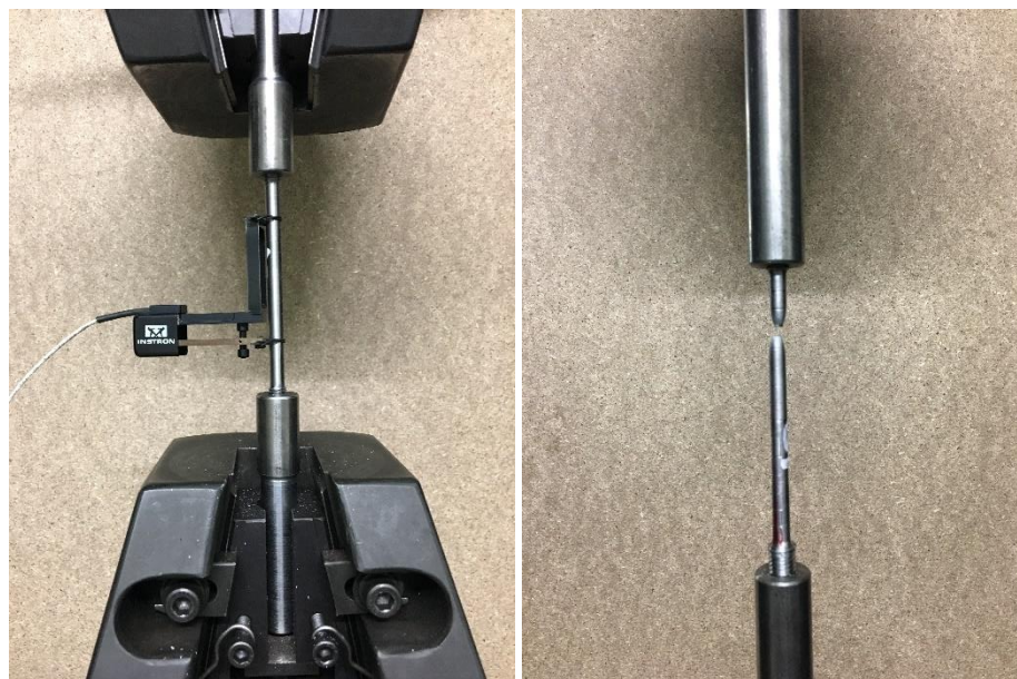
Abb. 2-6: Versuchsaufbau Zugversuch mit Rundprobe (links), Probekörper nach Versagen (rechts)
