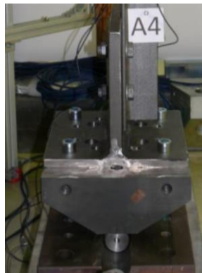
Abb. 2-11: Darstellung der Verschiedenen Lagerungsbedingungen: BC1 – eingespannt, BC2 – Scharnier, BC3 - gelenkig
