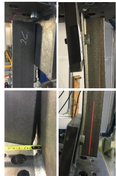
Abb. 4-23: Plastische Verformung des Winkels an den Anschlussblechen
