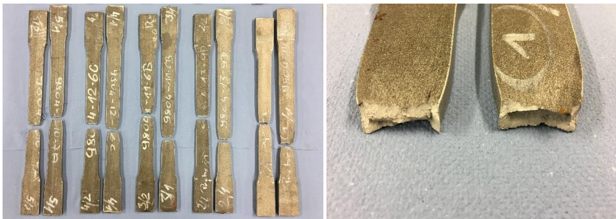
Abb. 2-9: Flachzugproben nach Versuchsdurchführung, Proben A-E (links), detailliertes Bruchbild (rechts)
