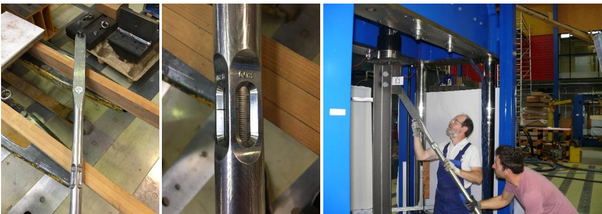
Abb. 2-15: Aufbringen der Vorspannkraft mittels Drehmomentschlüssel
