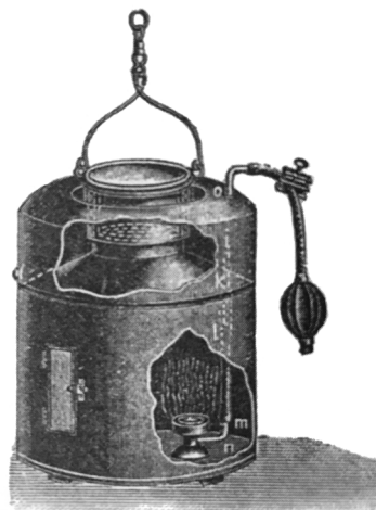
Abb. 8: Blechfischkanne mit Blasebalg-Belüftungsvorrichtung
