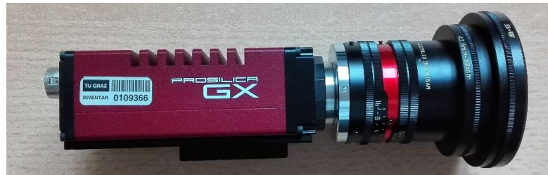
Abb. 28 PIV-Kamera Allied Vision Prosilica GX
