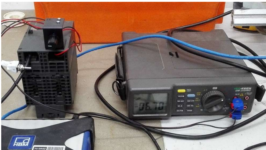
Abb. 21 Spannungsmessung mit digitalem Multimeter
