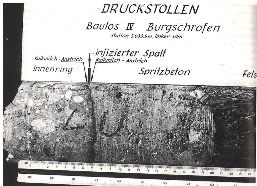
Abbildung 2.32: Bohrkern aus der Auskleidung des Druckstollens Kaunertal [45]
