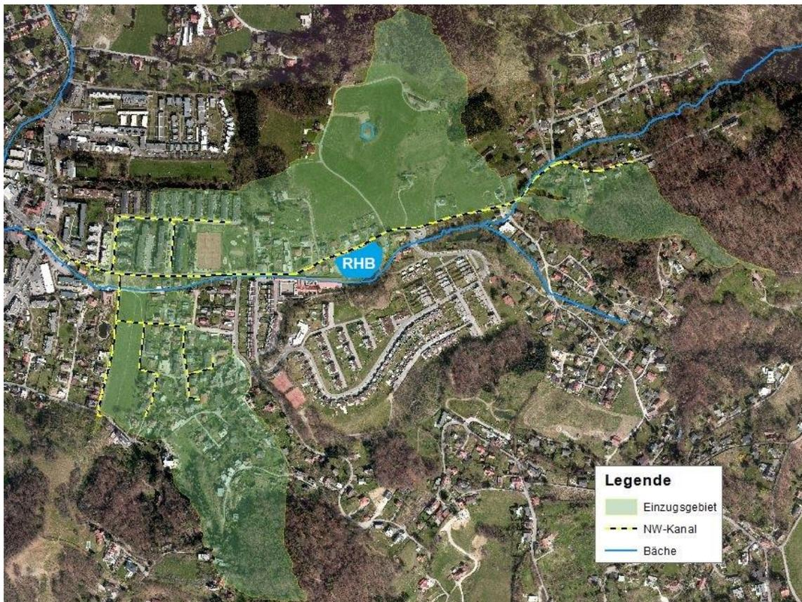
**Abbildung 2-10: NW-Kanal im Einzugsgebiet, der Stufenbach und das Rückhaltebecken (RHB)**
