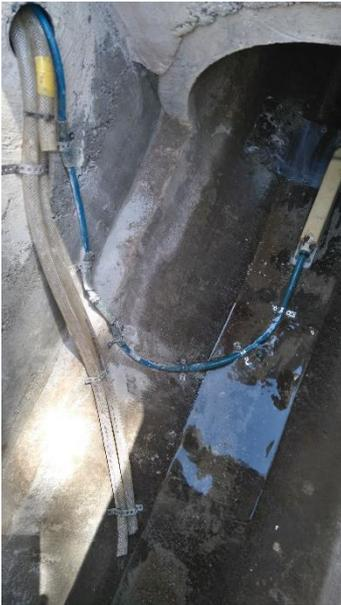
Abbildung 2-15: Entnahmeschläuche im Kanal für die automatische Probenahme
