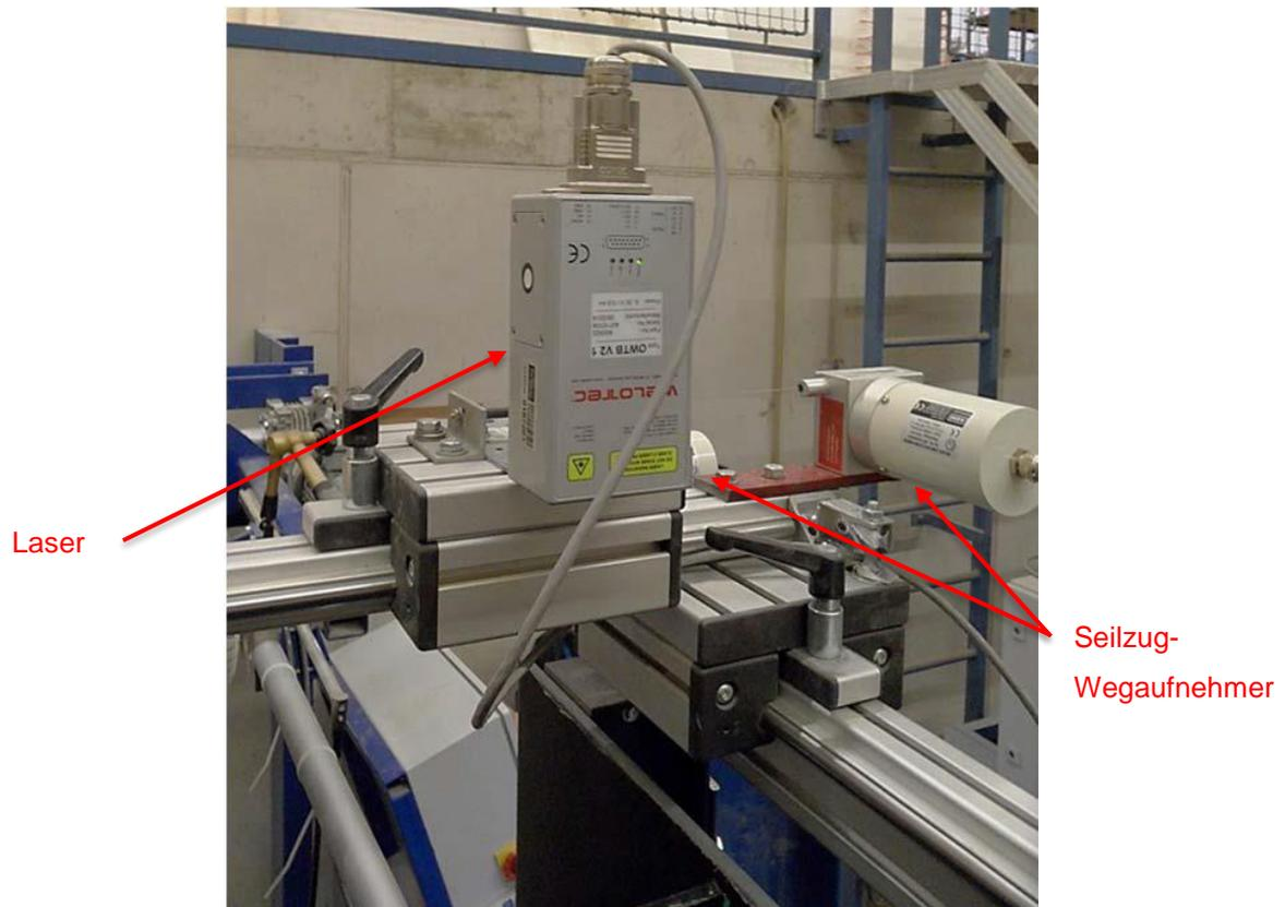
Abbildung 29: Lasermesssystem
