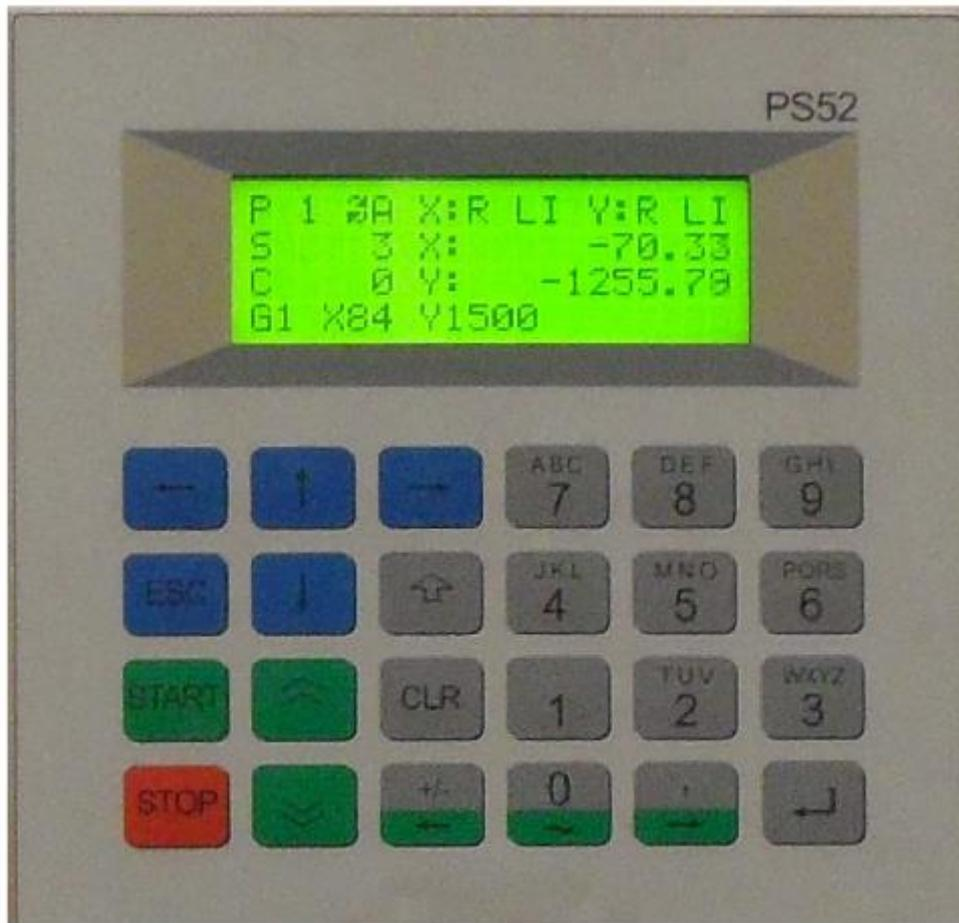
Abbildung 27: Bedienfeld der Motorensteuerung
