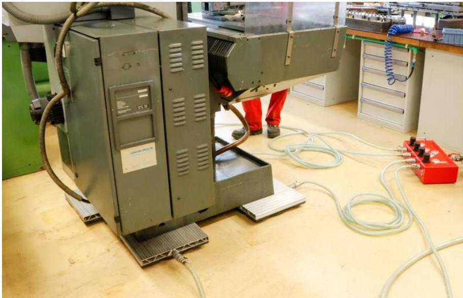
Abbildung 27: Luftkissentransport einer Fräsmaschine
