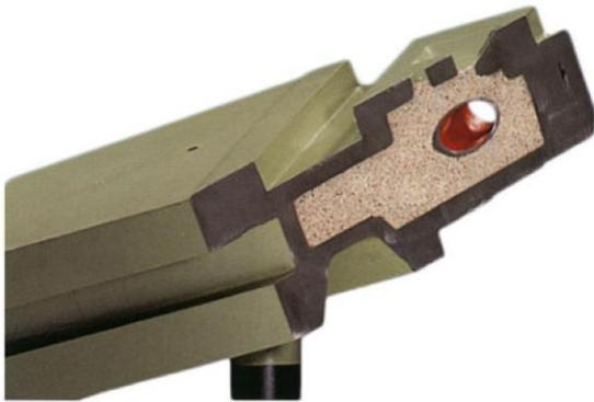
Abbildung 16: Mit Polymerbeton ausgegossenes Stahlgussbauteil ( (Neugebauer, 2012), Seite 424)
