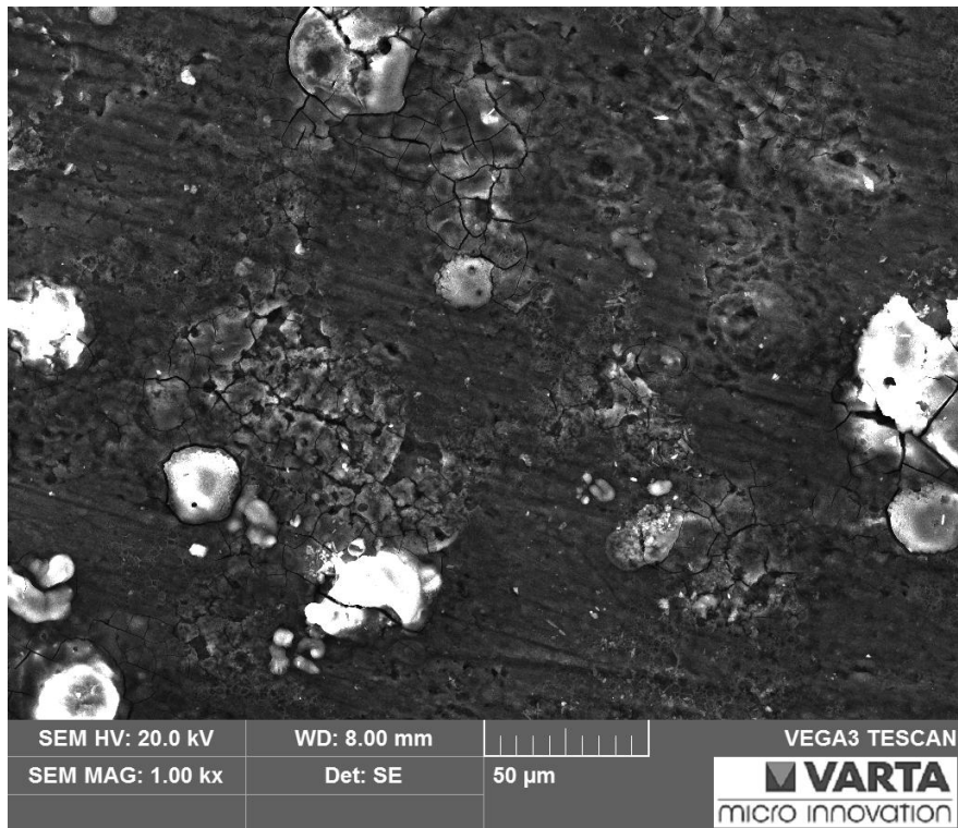
Anhang 45: REM-Aufnahme nach dem Cyclisieren bei j = 0,15 \text{ mA/cm}^2 der Legierung MgGd1,6.
