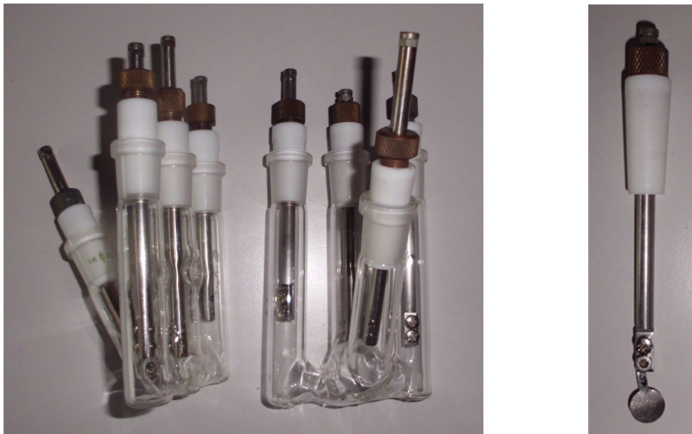
Abbildung 74: Batterieglaszellen (links). Elektrodenhalterung mit ausgestanzter Elektrode (rechts).
