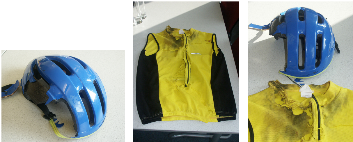
Abbildung 22: Beschädigungen des Fahrradhelms und Fahrrad T-Shirts aufgrund des Blitzeinschlages, Unfall 4.
