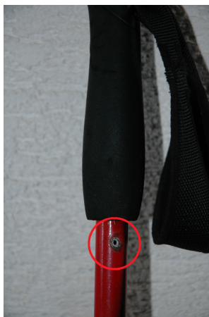
Abbildung 26: Ausschmelzungen durch den Blitzeinschlag am Nordic Walking Stock, Unfall 7.
