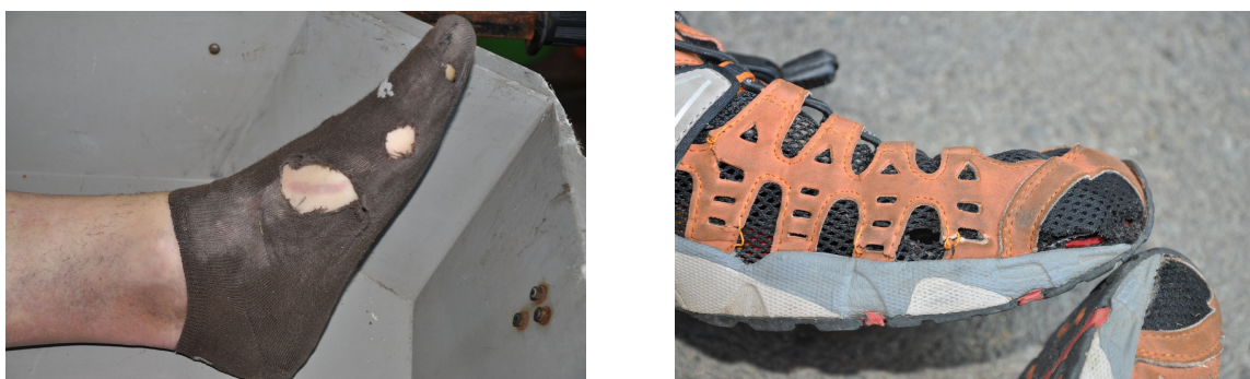
Abbildung 34: Beschädigungen der linken Socke und des linken Schuhs des Blitzopfers 1 des Unfalls 15.
