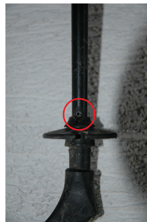
Abbildung 26: Ausschmelzungen durch den Blitzeinschlag am Nordic Walking Stock, Unfall 7.
