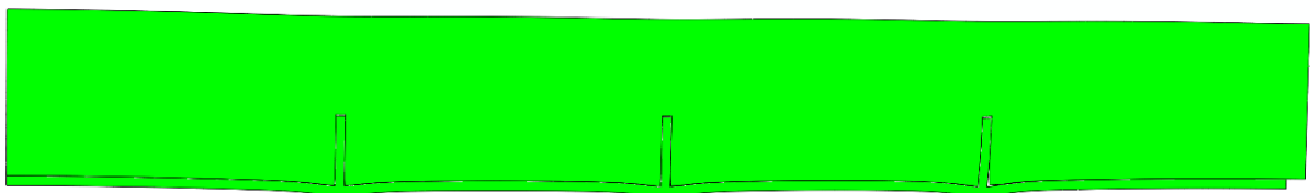
Abbildung A.64: Überhöhte Darstellung (200- fache) der Schubringverformungen im FE-Modell; Fall 1, LF1, t_{\text{Ring}} = t_{\text{Rohr}} = 45 \text{ mm} , h_{\text{Ring}} = 315 \text{ mm} , \mu = 0,25 , R = 1500 \text{ mm} , d_c = 750 \text{ mm} , e_{\text{Ring}} = R , V_F = 4000 \text{ N/mm}^2
