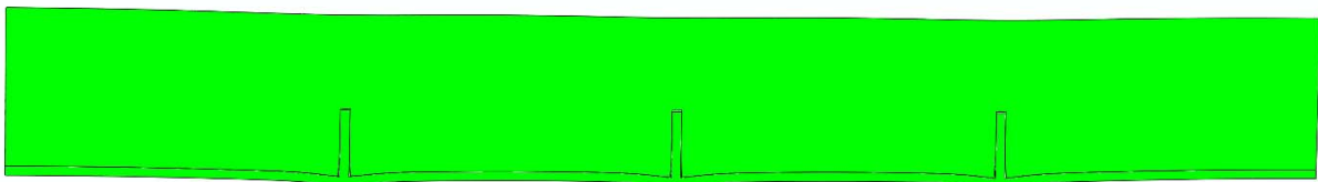
Abbildung 6.49: Überhöhte Darstellung (200- fache) der Schubringverformungen im FE-Modell; System SF1, LF1, t_{\text{Ring}} = t_{\text{Rohr}} = 45 \text{ mm} , h_{\text{Ring}} = 315 \text{ mm} , \mu = 0 , R = 1500 \text{ mm} , d_c = 750 \text{ mm} , e_{\text{Ring}} = R , V_F = 4000 \text{ N/mm}^2
