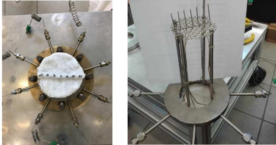
Abbildung 15: Auslassgitter und Befestigung der Thermoelemente; Rechts: Ansicht von oben, die Thermoelemente werden entlang der Rohre geführt und anschließend mit temperaturbeständigen Drähten am Gitter befestigt, um die Position zu fixieren. Links: Ansicht von der Seite.
