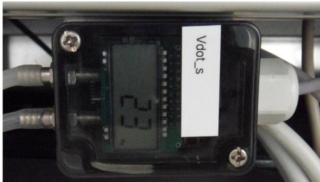
Abbildung 3-29: Differenzdruckmessumformer eingebaut
