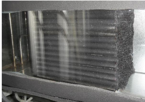
Abbildung 3-7: Strömungsgleichrichter Luftkanal
