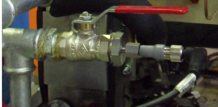
Abbildung 3-24: Eingebauter Pt-100 Messfühler
