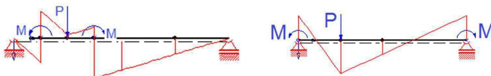
Abbildung 30: Momentenverlauf System S2-1KE [9]- links: externe Momente an den Enden des Grundelementes, rechts: externe Momente an den Trägerenden
