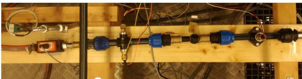
Abbildung 3-12: Foto der Messstrecke und Turbine des Labormodells
