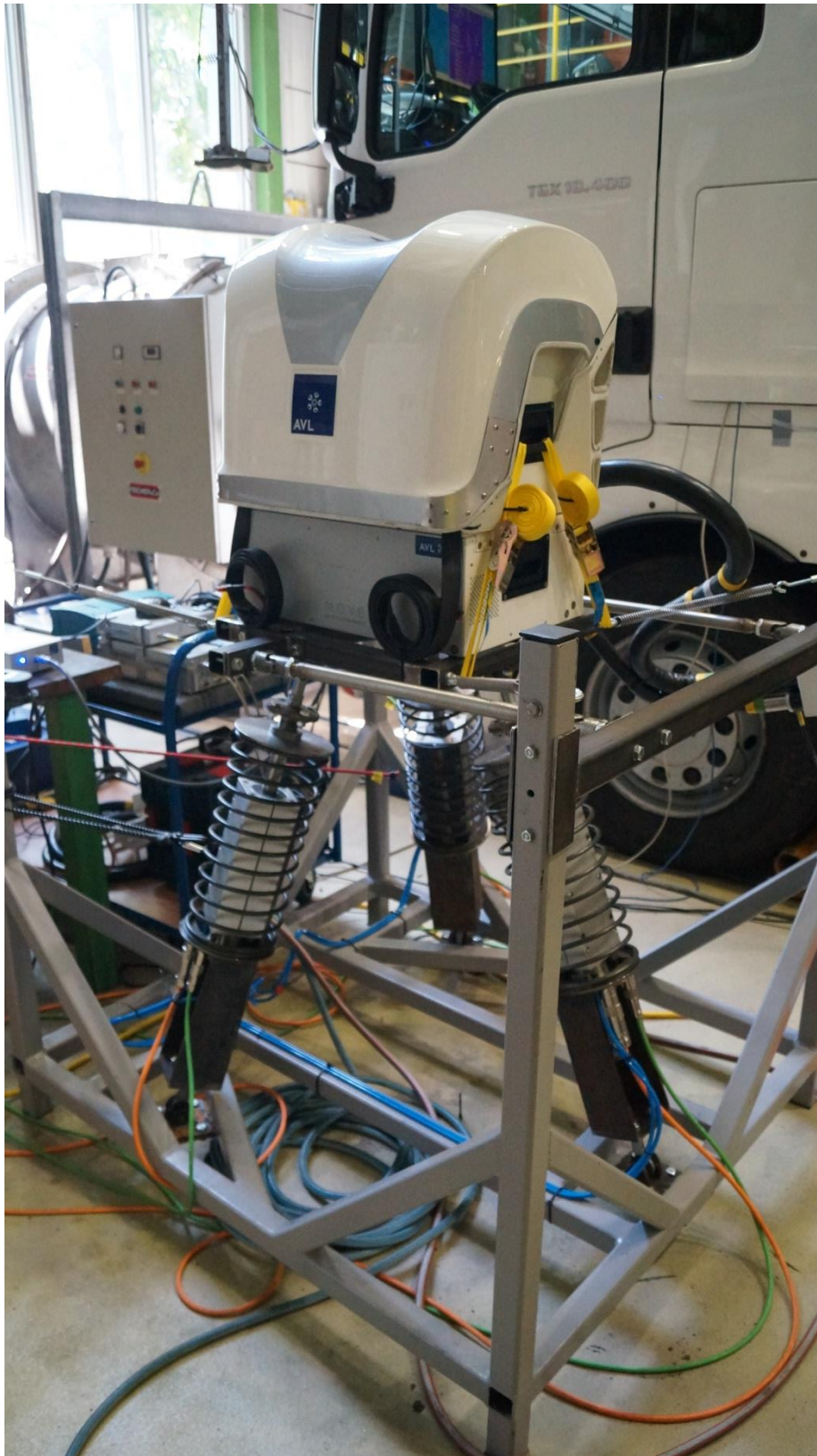
Abbildung 54: Kompletter PET mit aufgebautem AVL MOVE
