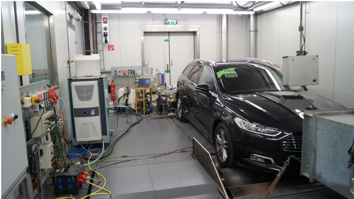
Abbildung 19: gesamter Messaufbau der DTT-Messung am PKW-Rollenprüfstand
