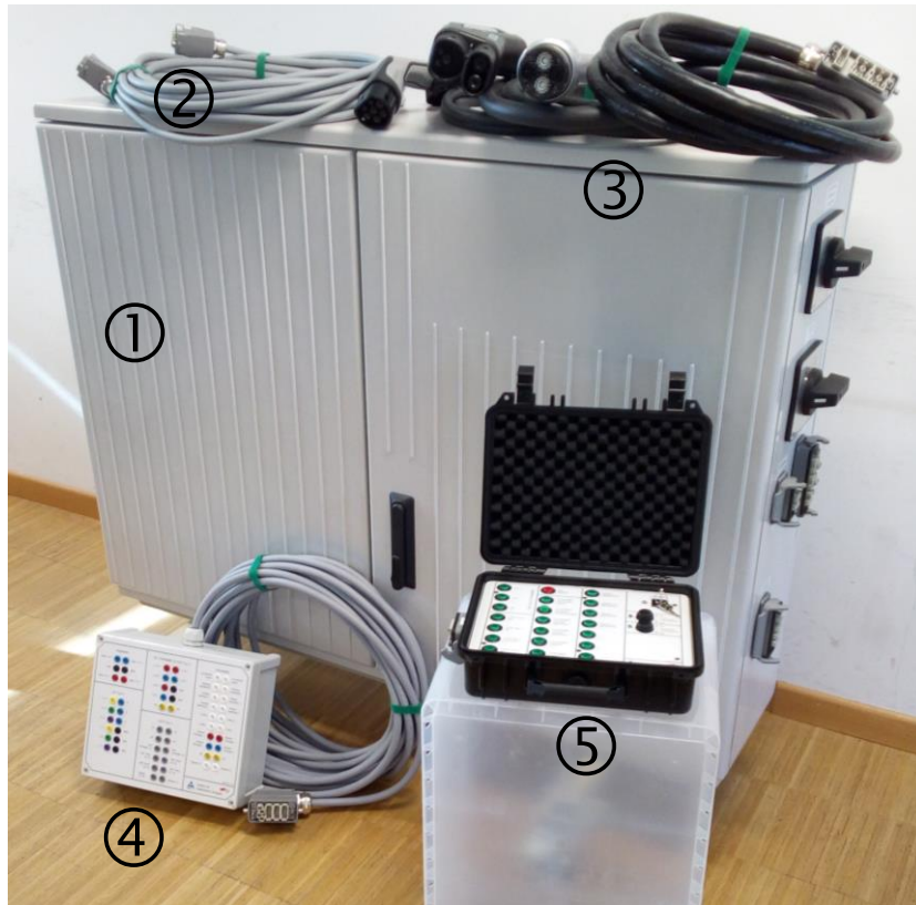
Abbildung 10: Messverteiler ① samt Zubehör (Leitung für kabelgebundene Fernbedienung ②, Ladeleitungsgarnituren ③, Messbox ④, Fernbedienung ⑤)
