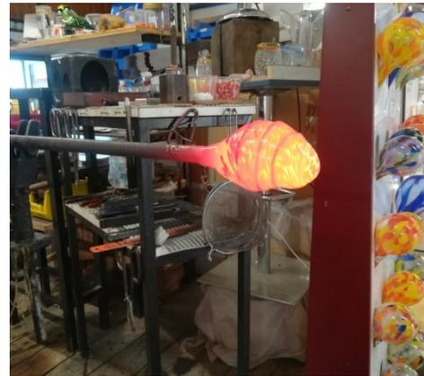
Abb. 29 erhitztes Glas bei der Bearbeitung
