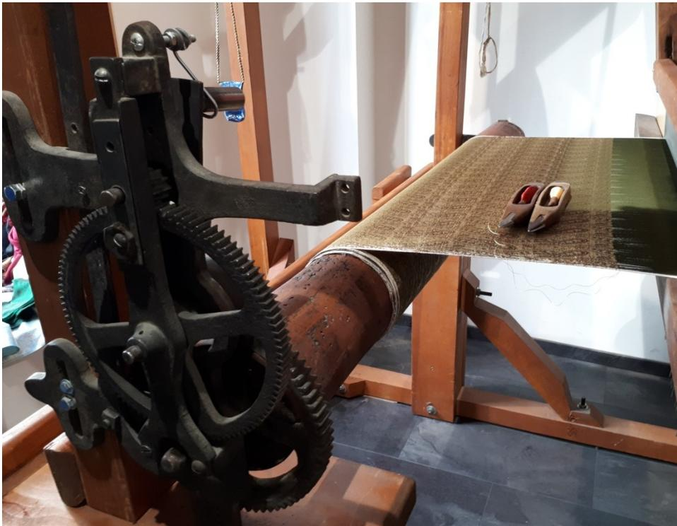
Abb. 17 Webstuhl mit den Schiffen, in denen die Seidenfäden gespannt werden
