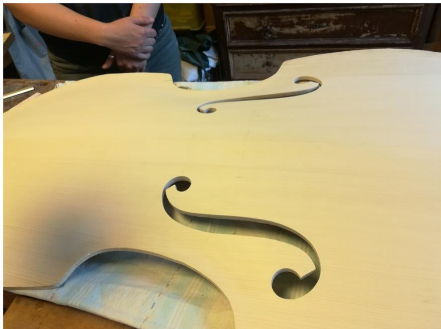
Abb. 25 Decke eines Cellos
