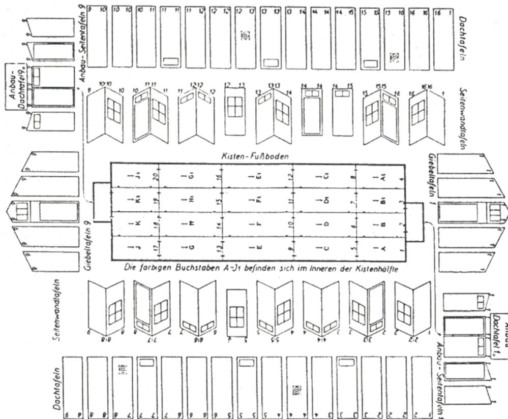
Abb. 20: Verzeichnis der Bauteile einer „Doecker Baracke“ um 1910
