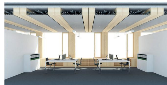
Den Schubverbund zwischen Beton und Leimbindern stellen Schrauben und Schubkerven her. Die Unterzüge bzw. Sturzträger aus Beton tragen wesentlich zur statischen Durchleitung der auftretenden Kräfte aus den Fassadenstützen bei. Mit einer Spannweite von 8m wird ein stützenfreier Raum garantiert und bedient damit das Bedürfnis nach Flexibilität in der Raumnutzung.<sup>74</sup>
