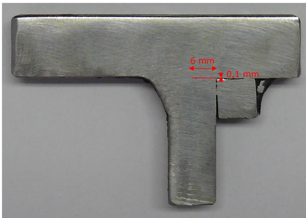
Abbildung 6.105: Stegdetail mit Spalt [Quelle: Markus Kettler, Februar 2018]
