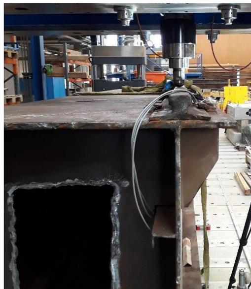
Abbildung 6.61: Tatsächliche Schienenlage über dem Steg [Quelle: Markus Kettler, Februar 2018]
