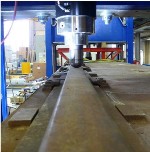
Abbildung 4.9: Laststempel
