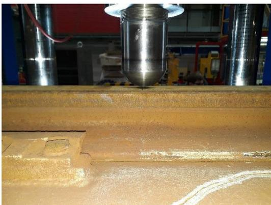
Abbildung 4.16: Laststempel (Foto)
