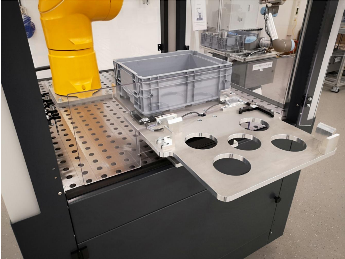
Abb. A 14 Beladungsgruppe mit einem eingeschwenkten KLT, Quelle: Eigene Darstellung.
