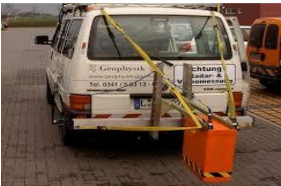
Abbildung 26: Zustandserhebung mittels Georadar ([http://www.geoleipzig.de/images/file/gf2010\\_f3\\_2.pdf](http://www.geoleipzig.de/images/file/gf2010_f3_2.pdf), letzter Zugriff: 07.08.2018)
