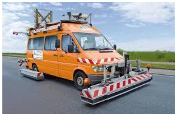
Abbildung 27: Zustandserhebung mittels Schnellfahrender Messsysteme ([https://mwvlw.rlp.de/fileadmin/isim/Unsere\\_Themen/Verkehr/Dokumente/Erlaeuterungen\\_zur\\_ZEB\\_2012.pdf](https://mwvlw.rlp.de/fileadmin/isim/Unsere_Themen/Verkehr/Dokumente/Erlaeuterungen_zur_ZEB_2012.pdf), letzter Zugriff: 07.08.2018)
