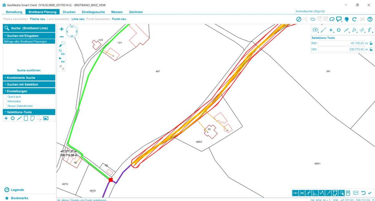
Abbildung 10: Breitbandprojekt des Bezirks Weiz. Pufferfläche einer geplanten Leitungsverlegung (eigene Aufnahme GMSC, 11.10.2018)
