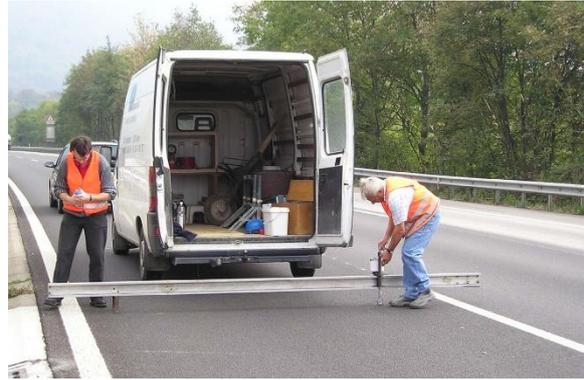
Abbildung 23: Zustandserhebung mittels Planum (39471359-Griffigkeit-und-ebenheit-von-deckbelaeagen-und-fgso.html, letzter Zugriff: 07.08.2018)
