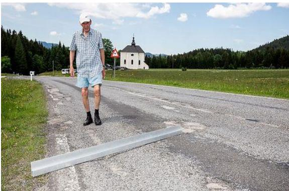
Abbildung 24: Zustandserhebung mittels Messlatte (<https://www.kleinezeitung.at/steiermark/muerztal/> letzter Zugriff: 07.08.2018)
